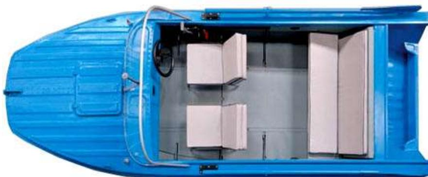
Мотор казанки мощный, в среднем — 50 лошадиных сил. Скорость катера с полной допустимой нагрузкой составляет 34 км/час, если же в катере находится два человека, то она увеличивается до 57 км/час. Мотолодка казанка 5М4 создана для отдыха на воде: длительных путешествий, прогулок по озерам, рекам и водохранилищам при расстоянии от прибрежной зоны до 5000 м, а также на море при удалении от берега до 4000 м и волнами до 1,25 м.
